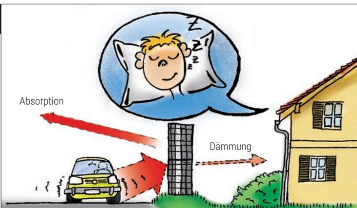
**VARIANTE 1****Fertig-Gabione mit Lärmschutzkern**
