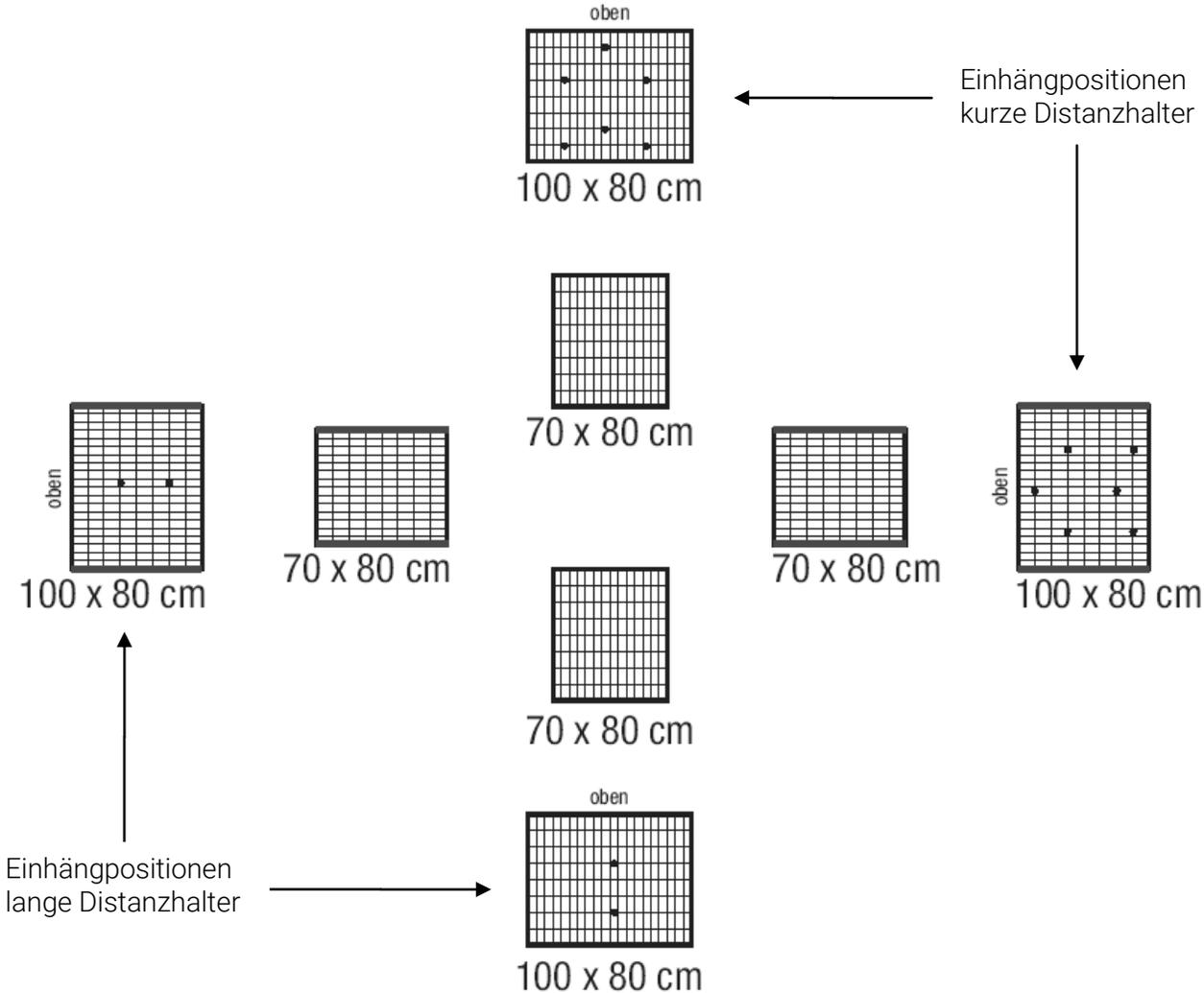
Die Distanzhalter sind **nicht nur** eine Einbauhilfe. Sie haben eine statische Funktion. Achten Sie deshalb auf deren korrekten Einbau.
