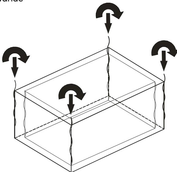
Die vertikal (von oben nach unten) verlaufenden Drähte der Matten müssen sich an der Hochbeet-Außenseite befinden.
