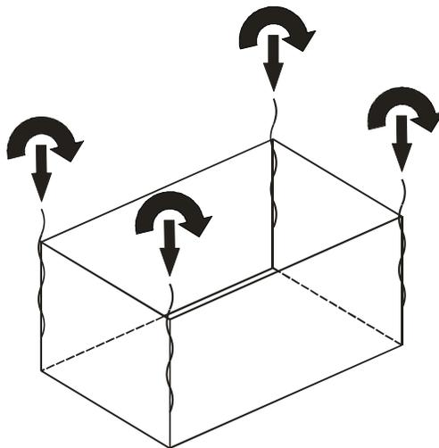
Die vertikal (von oben nach unten) verlaufenden Drähte der Matten müssen sich an der Hochbeet-Innenseite befinden.
