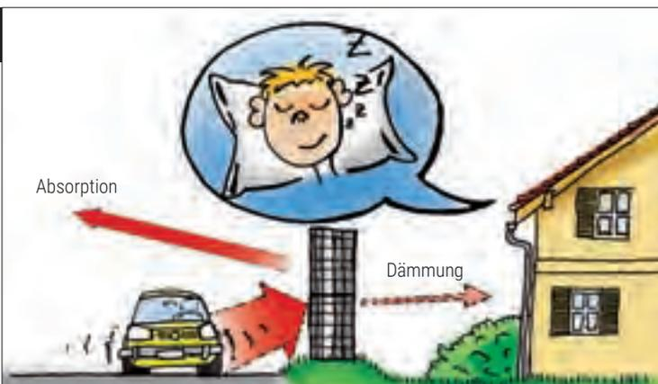
**VARIANTE 1****Fertig-Gabione mit Lärmschutzkern**
