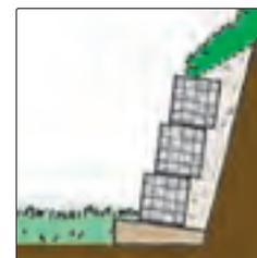
Eine gestufte und/oder geneigte Bauweise ist bei Stützmauern erforderlich.
