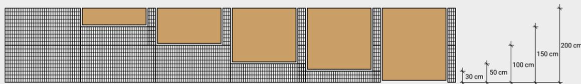
Die braunen Felder symbolisieren Elemente aus Holz, Alu, etc. Die Elemente werden ganz einfach an den herausragenden Laschen angeschraubt. Es kann zum Beispiel auch ein klassischer Gartenzaun mit Sockel und Säulen gebaut werden. Variante 1 und Variante 2 können miteinander kombiniert werden.
