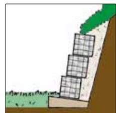
Eine gestufte und/oder geneigte Bauweise ist bei Stützmauern erforderlich.
